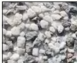
Nordischweiß® mit Granit und Weißzement , Korngröße: 5-8
